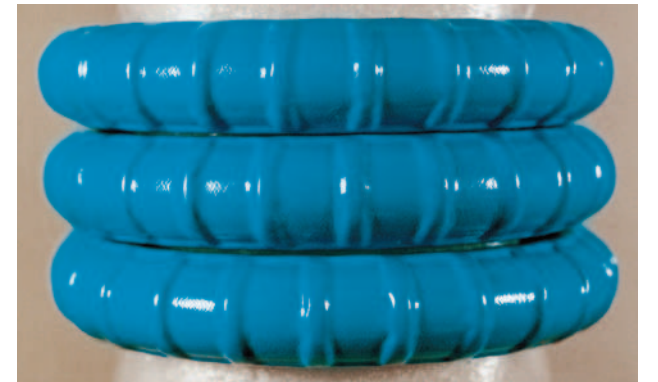
5℃、曲げ半径1.5φ180° 曲げ加工後の外観
