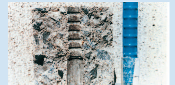
割裂後の供試体 (塗膜損傷なし)
