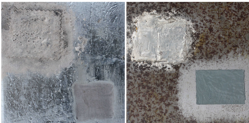
溶融亜鉛めっき板の左上と右下に不めっきを作り左上にAG-EGALを施工 鋳鉄鋼板の左上にAG-EGALを施工右下にジンクリッチペイントを塗装
